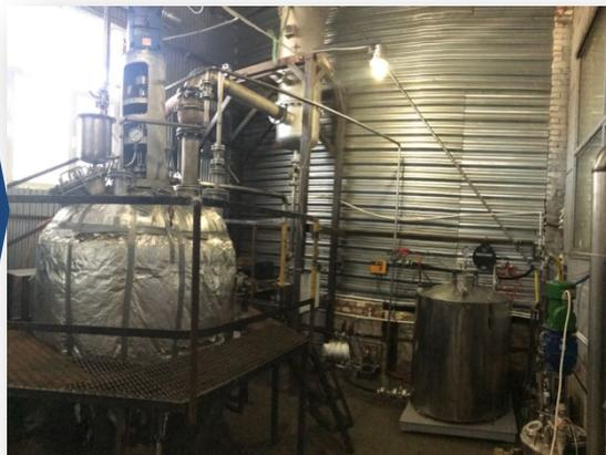
Производства клея в реакторе
